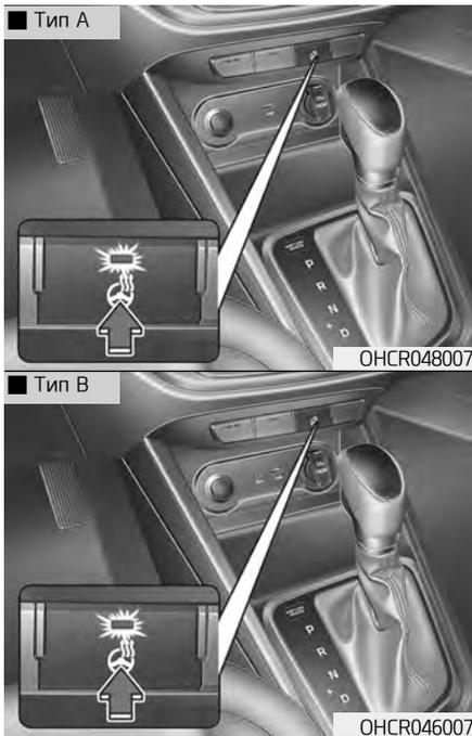
Обогрев рулевого колеса включается нажатием кнопки при включенном зажигании или при работающем двигателе. На кнопке загорится индикатор.
