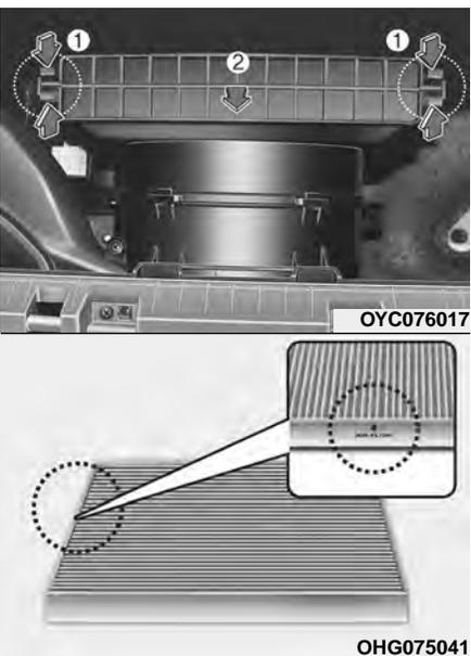
2. Снимите крышку воздушного фильтра системы управления микроклиматом при нажатии замка с обеих сторон крышки.
