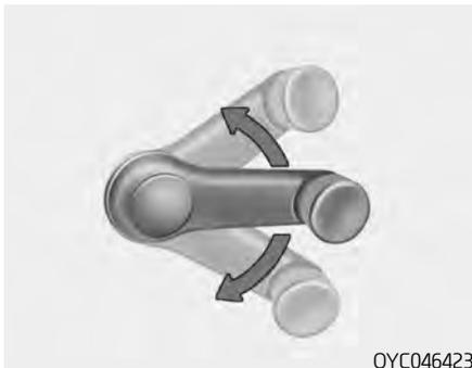
Поднятие или опускание стекла осуществляется поворотом рукоятки стеклоподъемником по часовой стрелке или против часовой стрелки с правой стороны. С левой стороны — в противоположном направлении.
