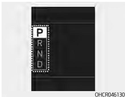
Всплывающий индикатор появляется на комбинации приборов на 2 секунды и отображает текущее положение рычага селектора при переключении диапазонов (P/R/П/D).
