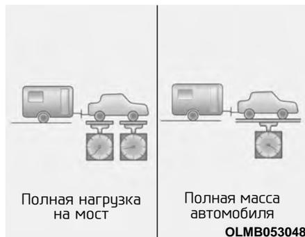
Нагрузка на дышло прицепа имеет большое значение, поскольку влияет на полную массу автомобиля. Нагрузка на дышло прицепа не должна превышать 10% от полной массы прицепа, загруженного в пределах максимально допустимой нагрузки на дышло.
