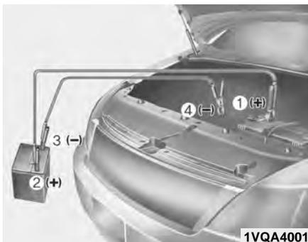
4. Присоедините кабели для запуска двигателя от внешнего источника (пусковые кабели), строго следуя указанной на рисунке последовательности. Сначала подсоедините один конец пускового кабеля к красному плюсовому (+) выводу разряженной АКБ (1).
