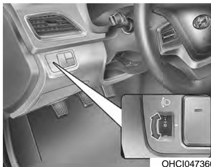
Для регулировки наклона фар в соответствии с количеством пассажиров и весом груза в багажнике следует повернуть ручку регулятора угла наклона фар.
