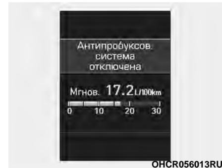
Кратковременно нажмите кнопку ESC OFF. Загорится индикатор ESC OFF и появится соответствующее сообщение (на автомобиле с дисплеем комбинации приборов). В этом состоянии функция контроля тягового усилия ESC (управление двигателем) деактивируется, но функция контроля тормозной системы ESC (управление торможением) остается активной.
