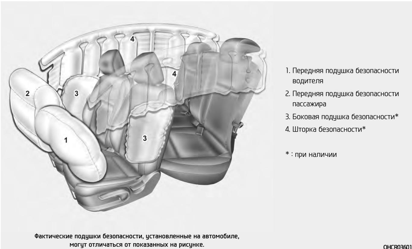
Автомобиль оснащен системой подушек безопасности для водителя и переднего пассажира.
