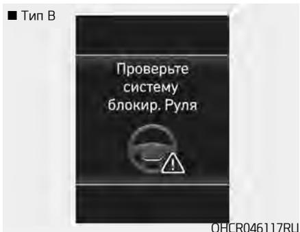
Это предупреждающее сообщение отображается, когда рулевое колесо не заблокировано обычным способом при выключении зажигания нажатием кнопки пуска/остановки двигателя.
