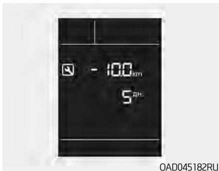
Если заданный интервал обслуживания превышен, то при каждом включении зажигания будет мигать символ (🔧).
