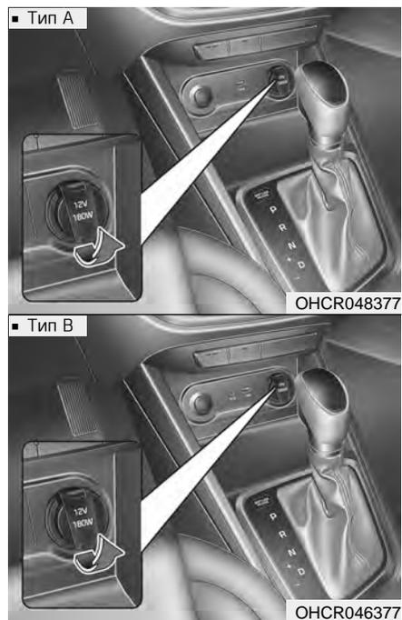
Электрическая розетка предназначена для питания мобильных телефонов или иных устройств, предназначенных для работы в электрической системе автомобиля. Устройства не должны потреблять более 180 Вт при работе двигателя.
