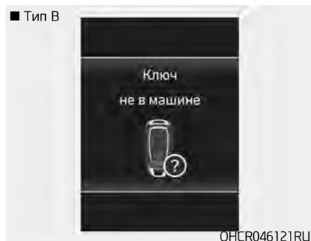
Это предупреждающее сообщение отображается при открывании или закрывании двери, если кнопка пуска/остановки двигателя находится в положении АСС. Имея при себе электронный ключ, нажмите кнопку запуска и остановки двигателя.
