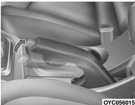
Прежде чем покинуть автомобиль, обязательно задействуйте стояночный тормоз.
