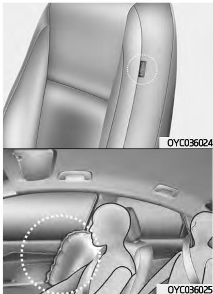
Данный автомобиль оснащен боковыми подушками безопасности в каждом переднем сиденье. Подушки безопасности предназначены для дополнительной
