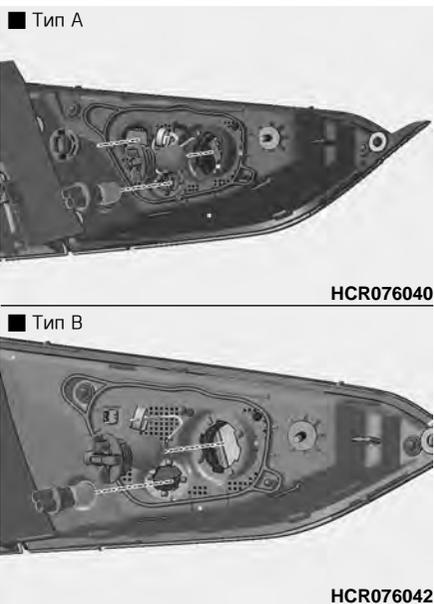
**Лампа фонаря заднего хода, лампа заднего фонаря, лампа заднего противотуманного фонаря**
