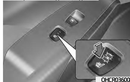
При работающем двигателе включите обогреватель сиденья водителя или пассажира.
