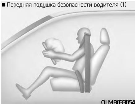
Когда блок управления подушками безопасности обнаруживает достаточно серьезный удар в переднюю часть транспортного средства, он автоматически надувает передние подушки безопасности.
