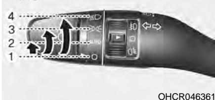
Для управления осветительными приборами поверните ручку на торце подрулевого переключателя в одно из следующих положений:
