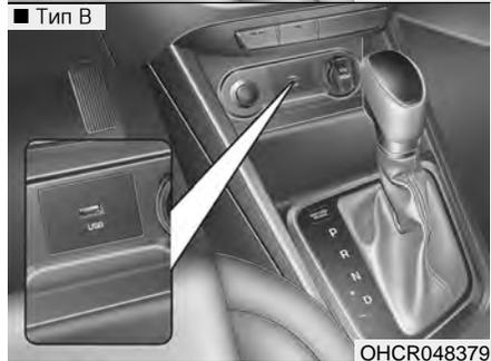
Для подключения портативных аудиоустройств могут использоваться разъемы AUX (при наличии), USB или iPod®.
