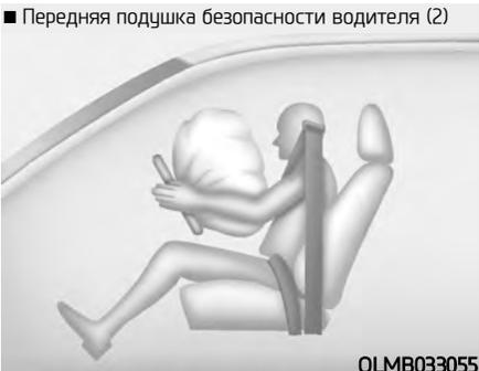
После срабатывания происходит разрыв швов мягкой крышки, которая отделяется под давлением при расширении подушек безопасности. Последующее открытие крышек позволяет полностью раскрыться подушкам безопасности.
