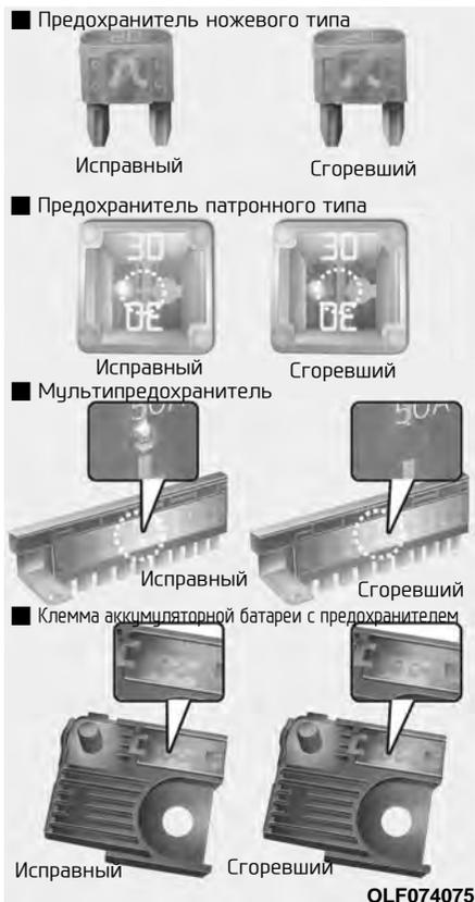
Для защиты электрической системы автомобиля от выхода из строя в результате электрической перегрузки используются плавкие предохранители.
