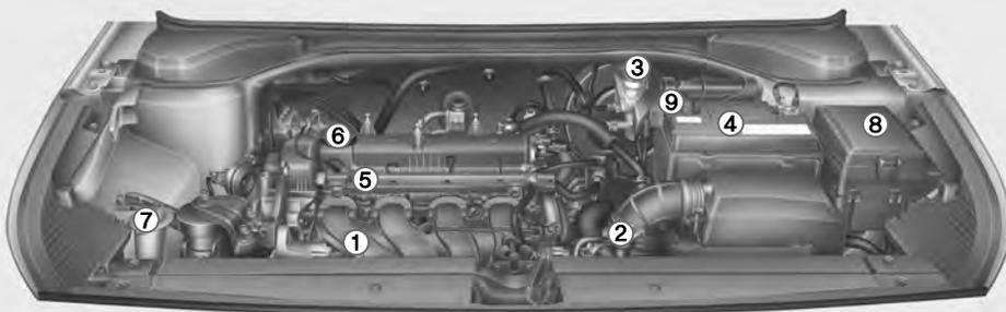
1. Расширительный бачок для охлаждающей жидкости двигателя
