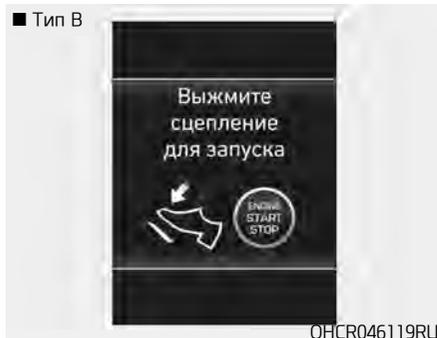
Это предупреждающее сообщение отображается, если кнопка пуска/остановки двигателя нажата в положение АСС дважды без нажатия педали сцепления. Нажмите педаль сцепления для запуска двигателя.
