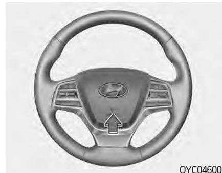
Для включения звукового сигнала нажмите на зону на рулевом колесе, обозначенную соответствующим символом (см. рисунок). Звуковой сигнал будет работать только во время нажатия на эту зону.
