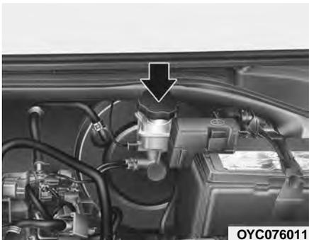
Периодически проверяйте уровень жидкости в бачке. Уровень должен быть между отметками MIN (Минимум) и MAX (Максимум) на боковой поверхности бачка.
