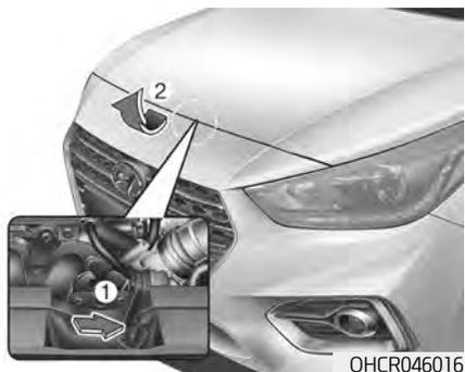
3. Подойдите к автомобилю спереди, приподнимите капот, поднимите вторичную защелку (1) по центру под капотом и откройте капот (2).
