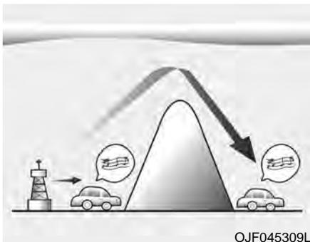
Сигнал AM передается на большее расстояние, чем сигнал FM. Это происходит потому, что радиоволны AM диапазона передаются на низких частотах. Эти радиосигналы с большой длиной волны и низкой частотой распространяются не по прямой линии в атмосфере, а могут огибать земную поверхность. Кроме того, они огибают препятствующие их распространению объекты, что обеспечивает лучший прием сигнала.
