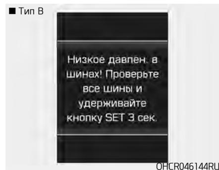
Это предупреждающее сообщение отображается при снижении давления в шинах. Также загорается пиктограмма соответствующего колеса.
