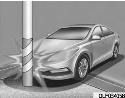
Подушки безопасности могут не раскрыться при столкновении автомобиля со столбом или деревом, когда удар сконцентрирован в одном месте, и энергия столкновения поглощена структурой транспортного средства.
