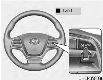
1. Для включения СИСТЕМЫ нажмите кнопку CRUISE / / MODE на рулевом колесе. Контрольная лампа круиз-контроля загорается.
