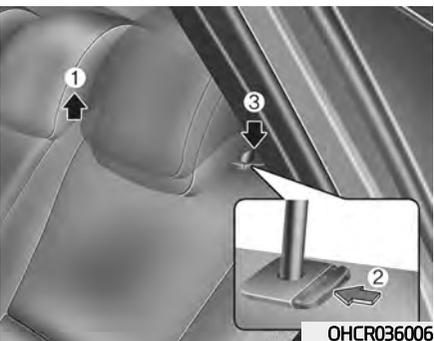
**Регулировка по высоте вверх и вниз (при наличии)**
