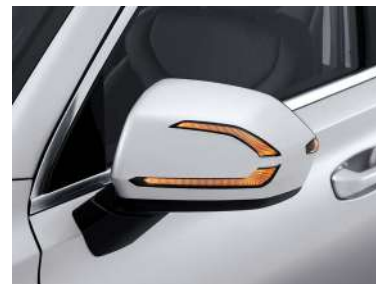
Сыртқы артқы көрініс айналарының корпустарындағы бұрылу көрсеткіштерінің жарықдиодты қайталағыштары
