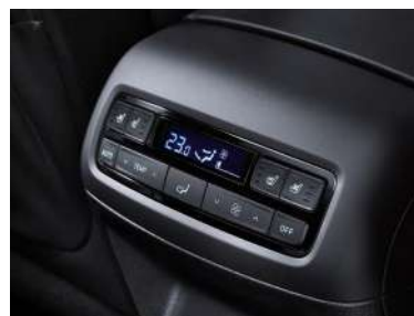
Тәуелсіз басқарылатын үш аймақтық автоматты баптау жүйесі
