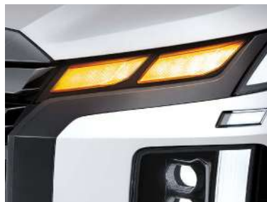
Hidden Lights технологиясына негізделген жасырын бұрылыс көрсеткіштері
