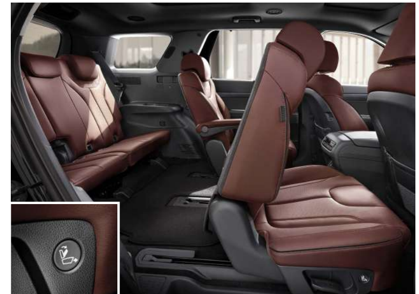
Бір рет түрту арқылы интеллектуалды бүктеу функциясы (WALK-IN батырмасы [салонның артқы жағы])
