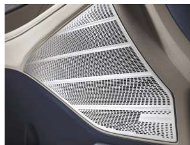
Алдыңғы есіктердегі металл торлары бар динамиктер
