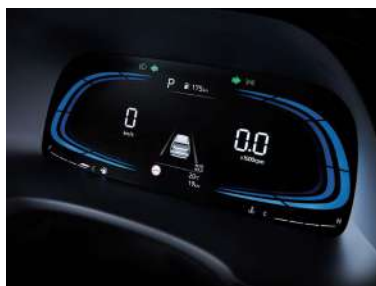
Диагонали 4,2 дюйм TFT экраны бар Supervision аспаптар тақтасы
