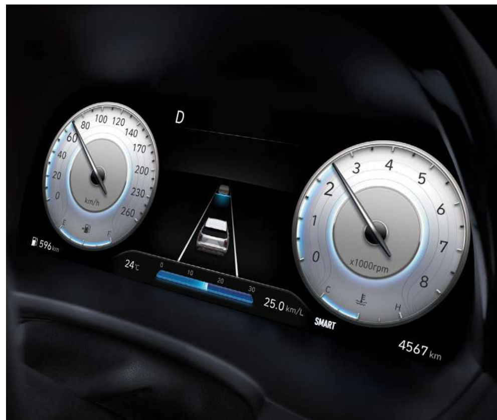
Диагонали 12,3 дюймдік Supervision цифрлық аспаптар тақтасы
