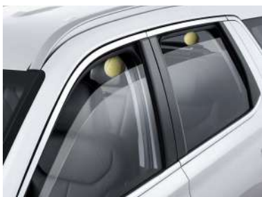
Электр жетектері мен қорғаныс құрылғылары бар әйнек көтергіштер
