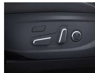
8 бағытта реттеуге және 2 бағытта бел бөлігінің тірегін реттеуге арналған электр жетегі бар жүргізуші орындығы
